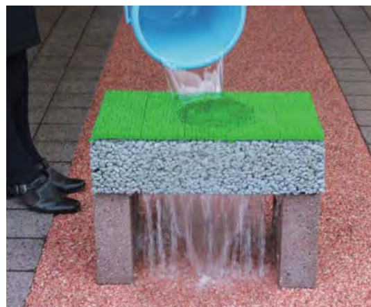
写真2：人工芝を乗せたポーラスコンクリートの透水状況
